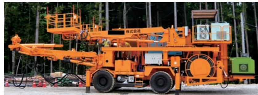
当社の定置式コンクリートポンプを搭載したコンクリート吹付け機
